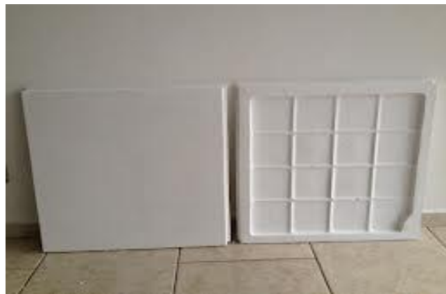
Foto 02 – Placas de Gesso 0,60 x 0,60 Lado Externo e Lado Interno
