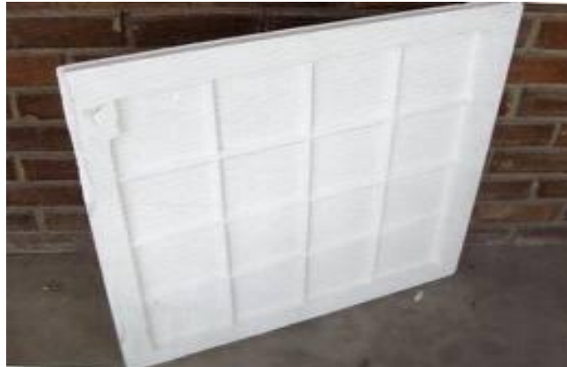
Foto 01 – Placas de Gesso 0,60 x 0,60 Lado Interno
