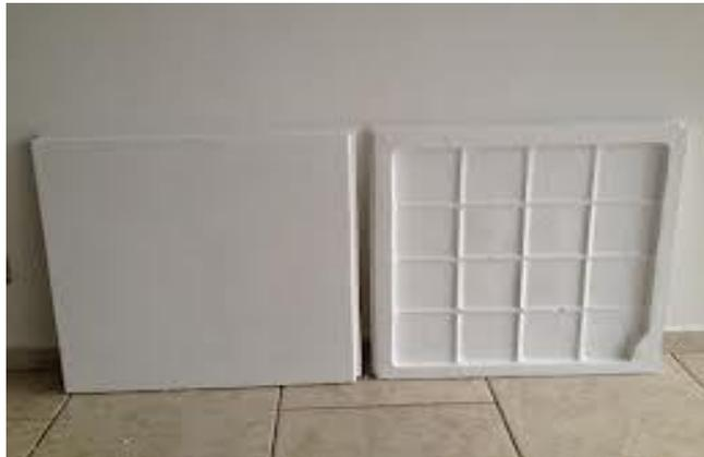
Foto 02 – Placas de Gesso 0,60 x 0,60 Lado Externo e Lado Interno
