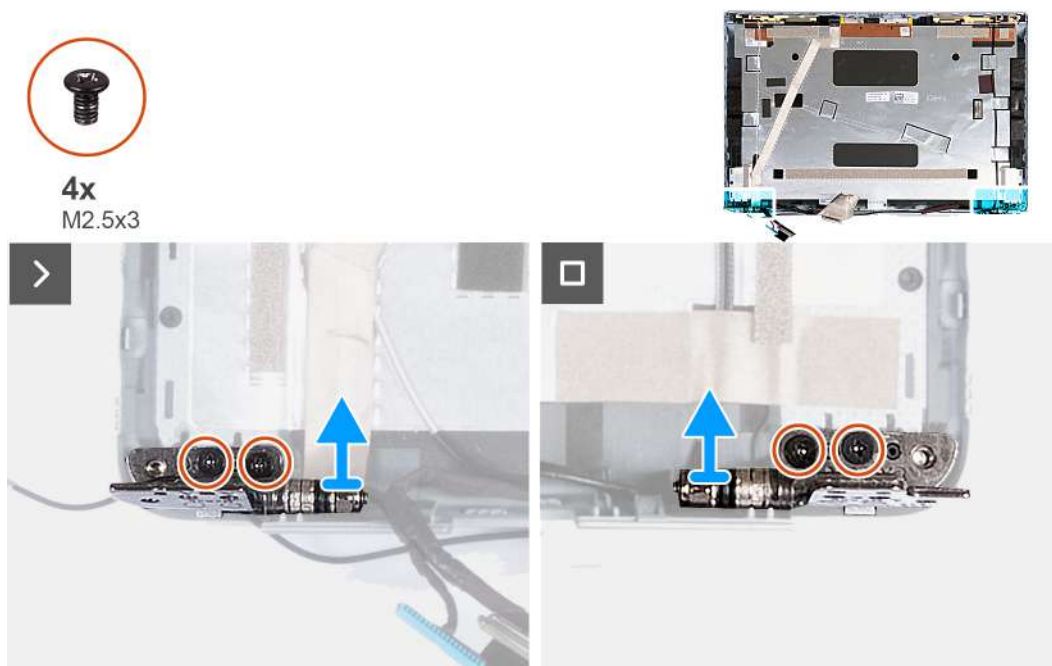
Figura 47. Como remover as dobradiças da tela
