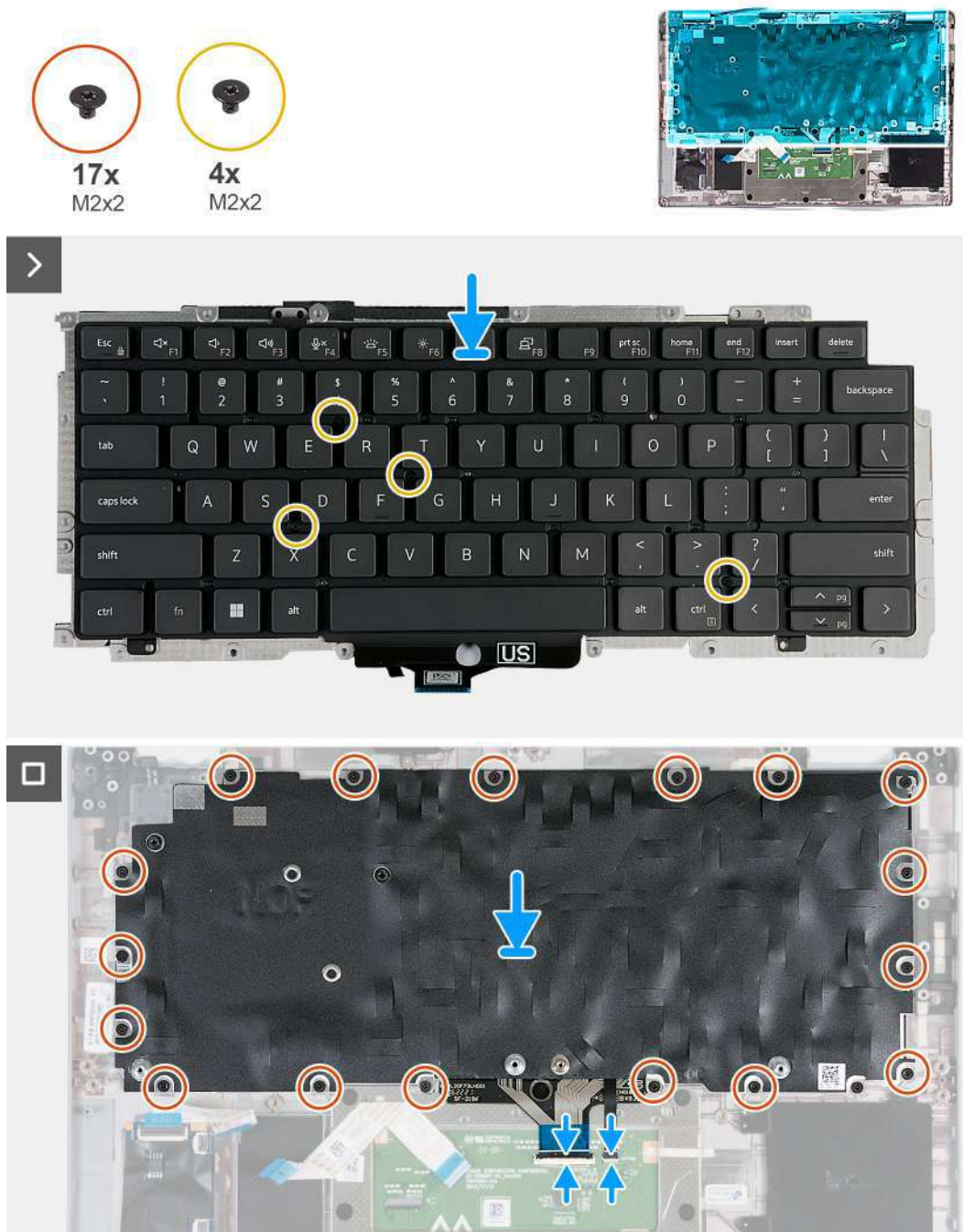
Figura 62. Como instalar o teclado
