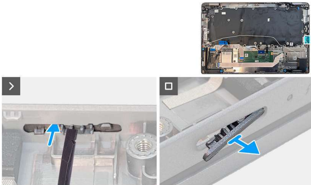
Figura 65. Como remover o preenchimento do slot de cartão SIM fictício
