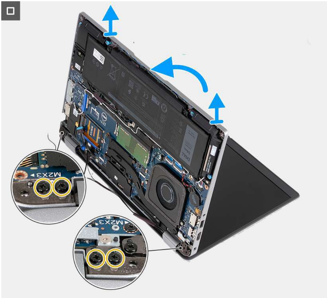
Figura 34. Como remover o conjunto da tela - computadores com placa 4G
