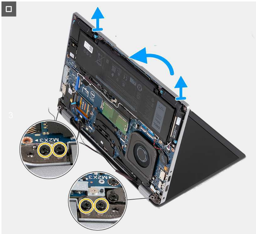
Figura 36. Como remover o conjunto da tela - computadores com placa 5G
