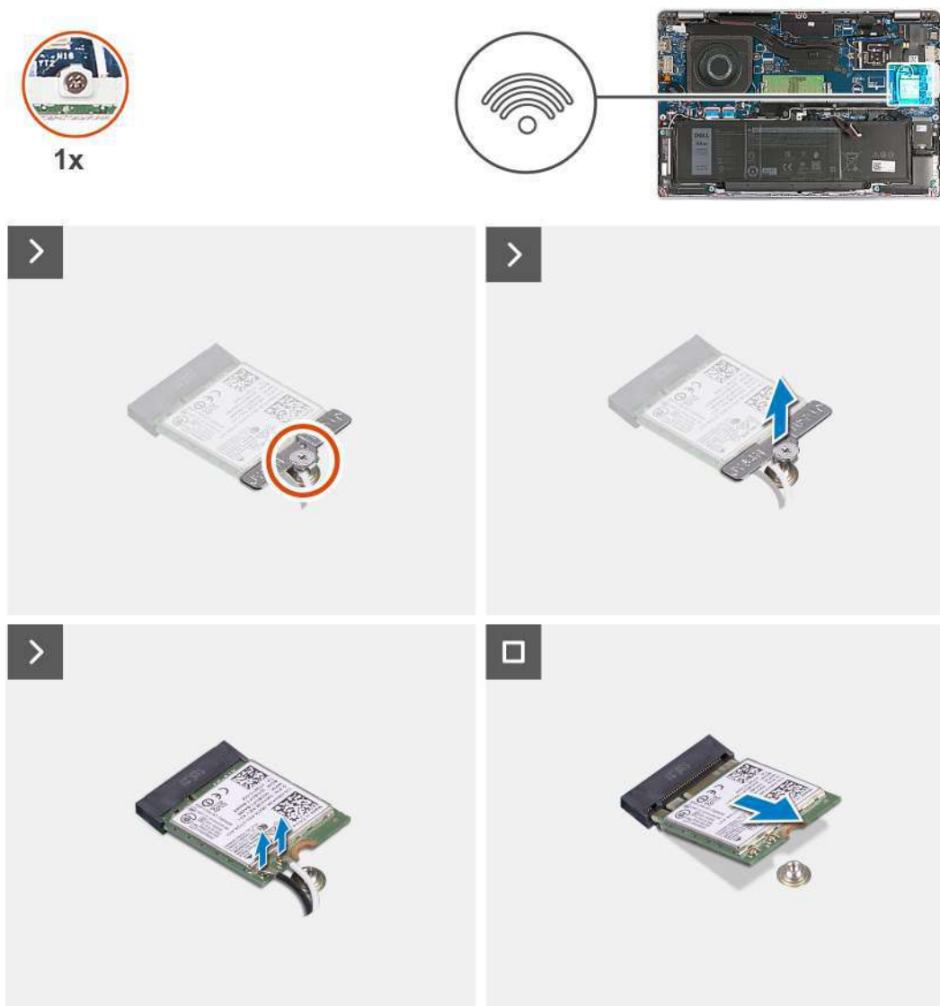
Figura 10. Como remover a placa de rede sem fio
