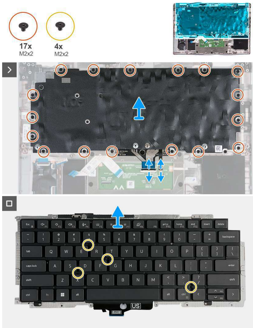
Figura 61. Como remover o teclado
