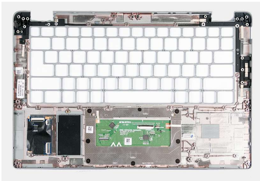
Figura 63. Como remover o conjunto do apoio para as mãos
